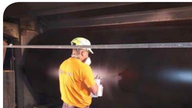
Traitement de surface à base de téflon pour de meilleures propriétés antiadhérentes sur les cylindres sécheurs.
