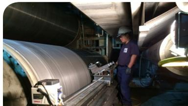
L'usinage de surface est appliqué en cas de fort écart de profil de surface ou d'impact important. (jusqu'à 1 mm / Ø)
