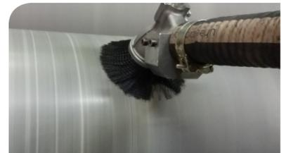
Une régénération de surface est nécessaire pour retrouver une rugosité de surface appropriée.
