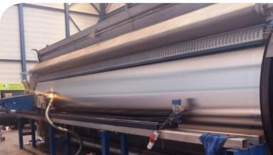
La rectification répare les problèmes de surface et de forme. Il améliore la capacité de séchage, réduit les ruptures de la bande de papier, améliore le profil du CD, prolonge la durée de vie du feutre et facilite le nettoyage. (jusqu'à 0,15 mm / Ø)
