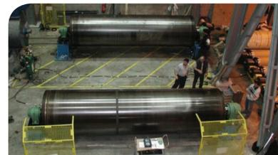
Балансировка может быть выполнена на месте без снятия комплектующих или в помещении заказчика после демонтажа. Это экономит много времени и затрат, которые в противном случае были бы понесены из-за простоя
