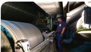
Механическая обработка применяется в случае значительных отклонений профиля (до 1 мм/Ø)
