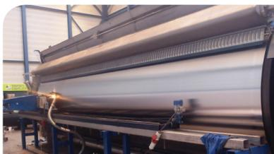
Шлифовка решает проблемы шероховатости, и профиля. Улучшается сушильная мощность, уменьшается частота разрывов бумажного полотна, улучшается профиль, продлевается срок службы сукна и облегчается шабрение (до 0,15 мм/Ø)
